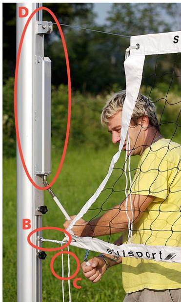
Avec la manivelle, l'écrou de serrage est tourné vers le haut et suspendu sur le crochet (A) du câble de tension. L'ajustement continu de la hauteur du filet n'est possible que lorsque le filet n'est pas sous tension. Avec la manivelle démontable vous réglez la tension du filet.
